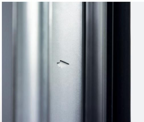
**Pfeil 1000** – auf der Höhe von 1000 mm von der Unterkante der vertikalen Zargen gibt es eine Pfeilmarkierung. Sie ermöglicht es, die korrekte Zargenhöhe genau zu bestimmen.
