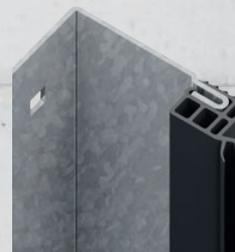
**Seitliche Dichtung** – Eine warme, vierkammerige Hart-Weich-Seitendichtung ist eine moderne und praktische Lösung. Durch die Verwendung einer Doppeldichtung und einer Vier-Kammer-Konstruktion werden einerseits Wärmebrücken am effektivsten eliminiert, andererseits wird ein sicherer Abstand zwischen Sturz und Torblatt geschaffen.
