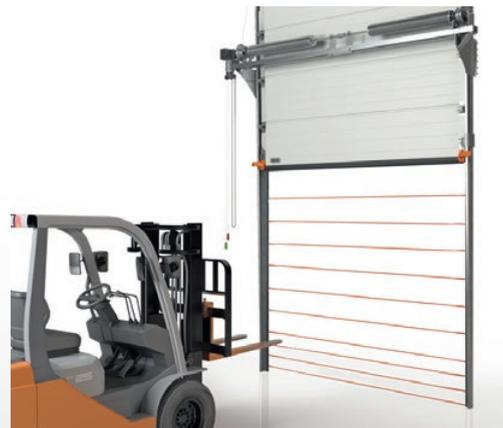
Tore MakroTherm XXL sind standardmäßig mit einem wirksamsten Schutz des Eingangslichts, nämlich einen 2668 mm hohen Lichtvorhang, ausgestattet. Ein dicht geflochtenes Netz von Lichtschranken verhindert, dass sich das Tor unkontrolliert schließt, wenn sich ein Hindernis im Lichte befindet.
