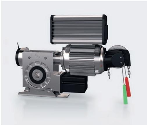
Das Tor ist standardmäßig mit einem elektrischen Antrieb GfA ausgestattet mit Spannungsversorgung 1x230 [V] oder 3x400 [V]. Der Antrieb ist in der Drehzahl stufenlos regelbar und bietet eine Soft-Start- und Soft-Stop-Funktion.
