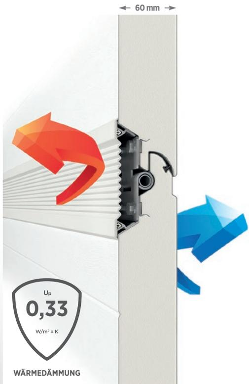
Für INNOVO-Paneele beträgt der Wärmedurchgangskoeffizient  $U_p = 0,33 \text{ W/m}^2 \cdot \text{K}$ .
